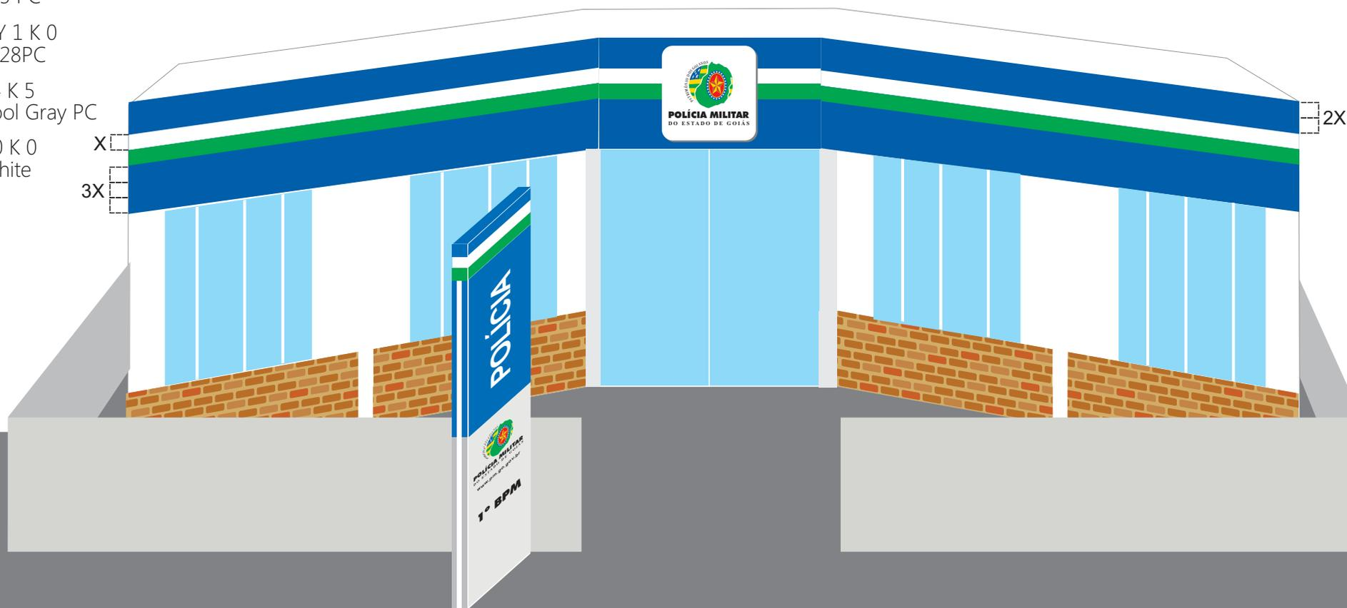
Versão com fachada sem tijolos à vista na base. Faixa pintada em cinza na base do prédio conforme escala de cor ao lado. A largura dessa faixa será de no mínimo 5X. A pintura interna será na cor branca.
